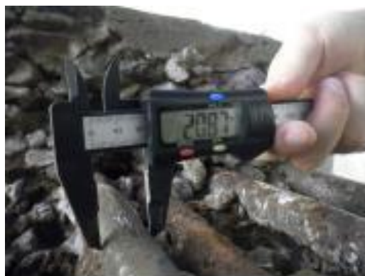
写真-7 鉄筋径の減少 ( \phi 21\text{mm} )
