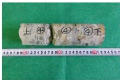
写真-8 床版部と上面増厚部の分離
