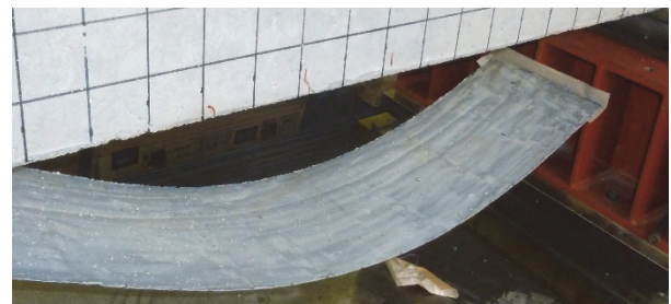
図-7 H-4 供試体の界面剥離状況
