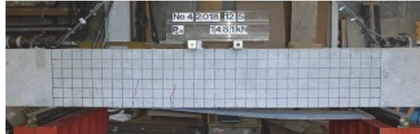
図-6 各供試体の破壊状況
