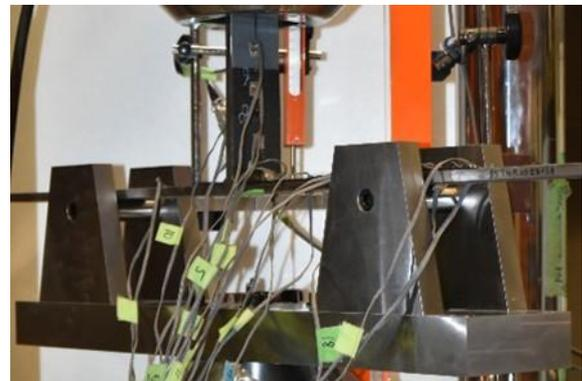
写真-2 セットアップ (曲げ圧縮試験)
