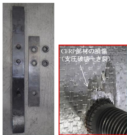
図-5 試験体 BJ-3 に発生した損傷
