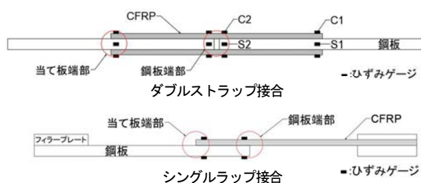
図-14 はく離箇所の表記とひずみ計測点
