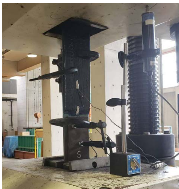
図-12 本試験 シングルラップ引張試験状況
