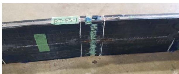
図-5 ダブルストラップ供試体 予備試験の破壊状況
