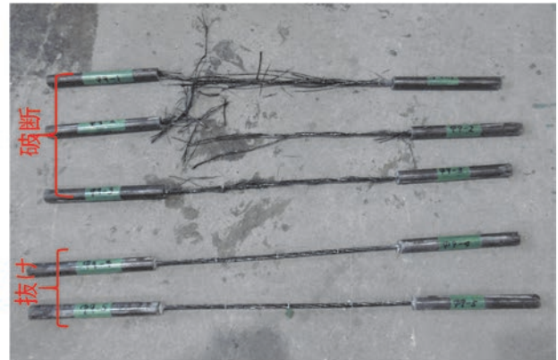
図-5 引張試験後の試験体の破壊形態
