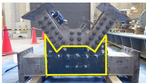
a) 試験体 S1A,S2A,W1A の CFRP 貼付け範囲
