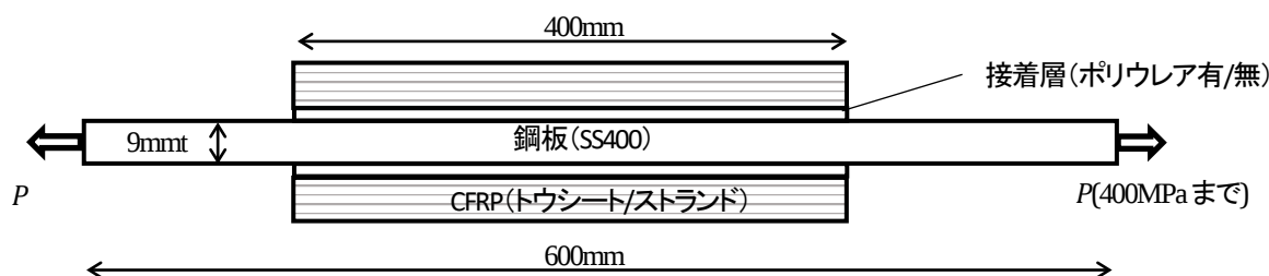
図-1 当て板厚みに関する検討用供試体断面
