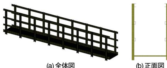
図6 C形直手すり形式の解析モデル
