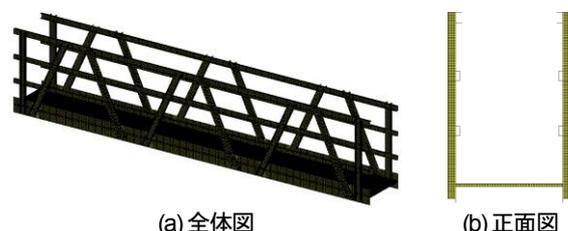
図5 逆C形トラス形式の解析モデル
