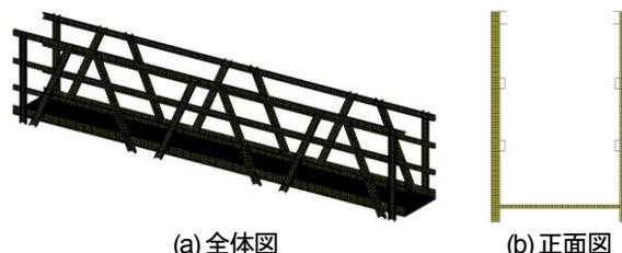
図4 C形トラス形式の解析モデル
