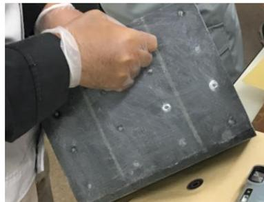
(c) CFRP板表面の目荒らし
