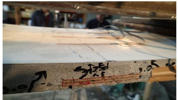
写真-3 破壊形状(曲げ破壊)
