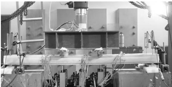
写真-3 静的載荷試験の様子
