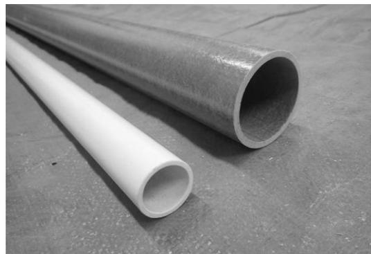
写真-1 GFRP 製パイプ
