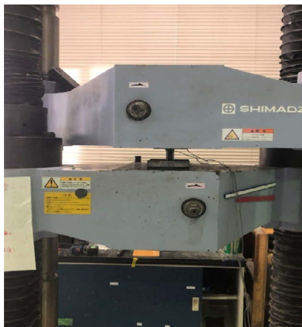
図-2 引張試験のセットアップの様子
