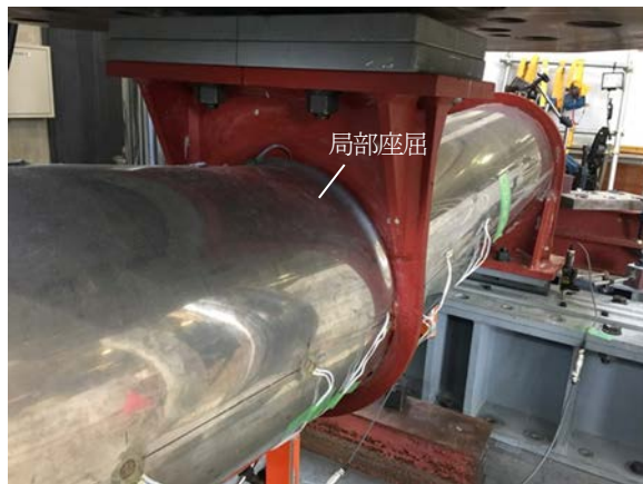
図-7 局部座屈発生状況
