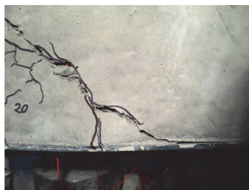
写真-1 頭無し供試体 1506 の破壊後における鋼板とコンクリートの剥離
