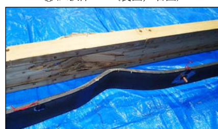
(h) 試験体 WB6 (破壊部詳細)
