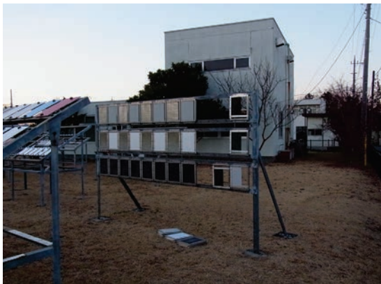
図-3 茨城県つくば市における暴露試験
