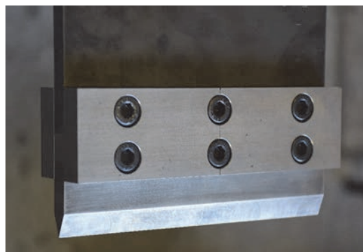
写真-1 鋼板端部に設置したナイフエッジの治具
