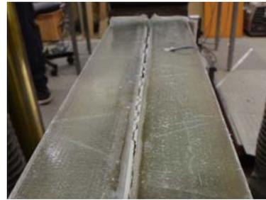
図-1 先行研究でのI形部材の破壊モード
