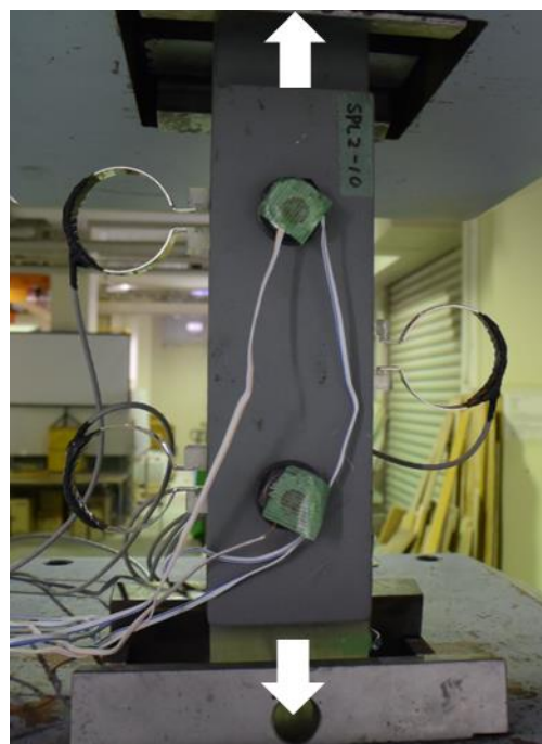
図-3 引張試験状況
