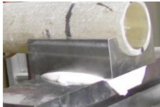
写真-1 曲げ試験支点
