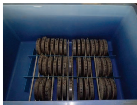
図-2 浸せき試験時の試験片設置状況
