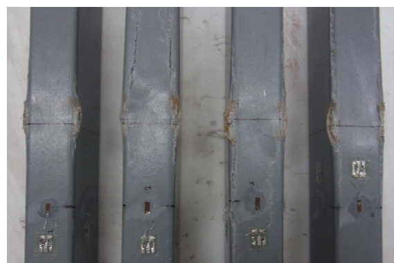
図-10 曲げ載荷実験の試験体の破壊状況
