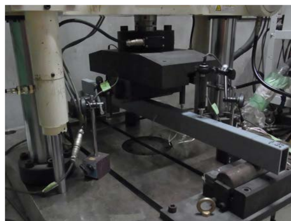
図-8 GFRP 水平材の曲げ載荷実験セットアップ図
