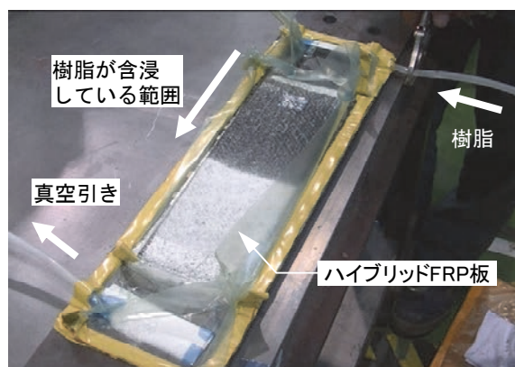
図-15 VaRTM成形によるHFRP板の鋼板への含浸・接着の状況
