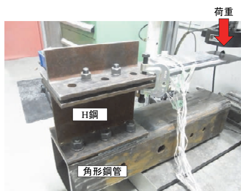
図-18 片持ちはりの曲げ試験のセットアップ図
