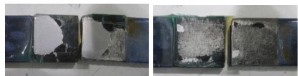
図6 2000時間照射後の接着面の破壊状態
