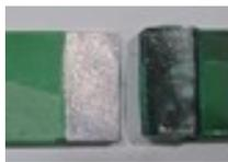
図8 100サイクル後の接着面の破壊状態
