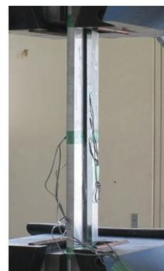
図2 引張剪断試験体セットアップ
