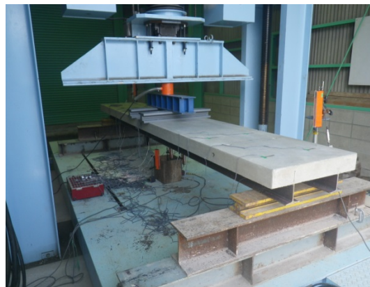
写真-1 荷重試験状況
