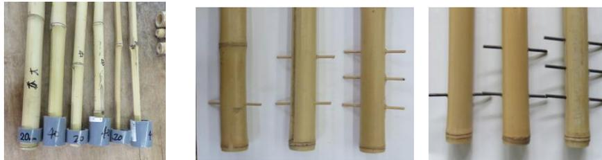
写真-2 新たに開発した定着部 (左からType B, Type C(竹棒), Type C(鉄筋))
