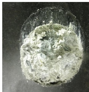
図-15 孔部コンクリートの破壊形状 (側圧がある場合)
