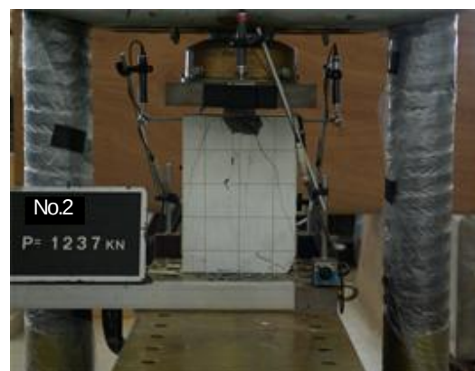
写真1 試験体破壊状況
