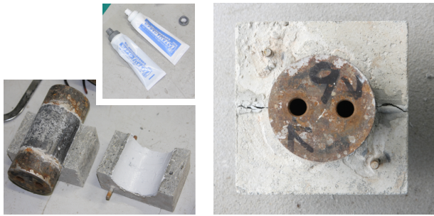
図-7 エポキシ系接着材で鋼モルタル界面を接合した供試体 (左:製作中の供試体, 右:トルク型せん断試験後)
