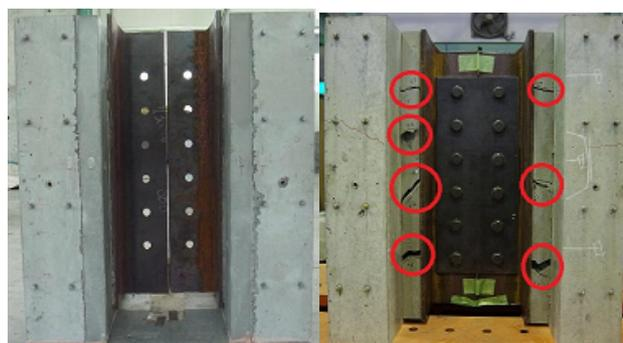
写真-1 NR3-W60 実験後の破壊性状 写真-2 NR3-W30 実験後の破壊性状
