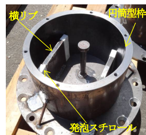
写真-3 コンクリート打設前の横リブありの試験体
