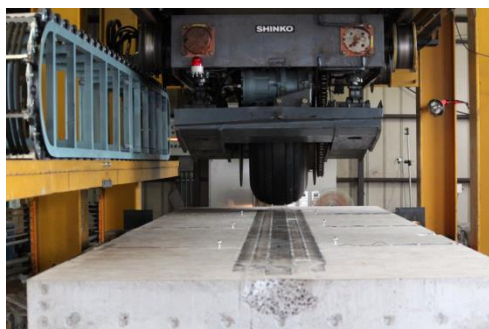
写真-3 輪荷重走行試験状況 (東京都戸田実験場2012/7/12撮影)
