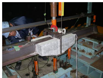
(d) 複合構造化後の供試体（正曲げ载荷試験状況）
