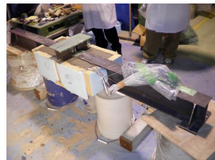
(c) 速硬軽量コンクリート打設後（保温材取付）
