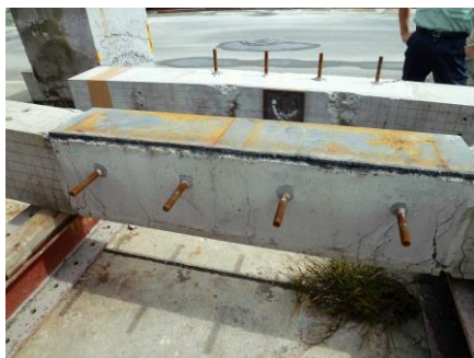
写真-8 負曲げ供試体終局時の鋼板内部状況
