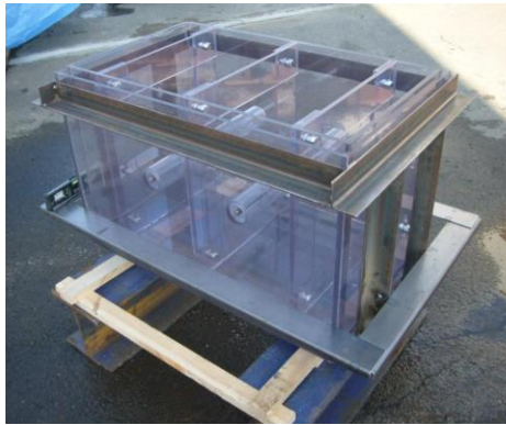
写真-2 グラウト充填確認試験用の供試体
