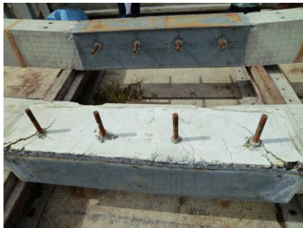
写真-7 正曲げ供試体終局時の鋼板内部状況
