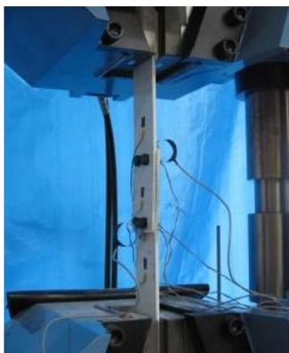
写真3 引張载荷時の様子
