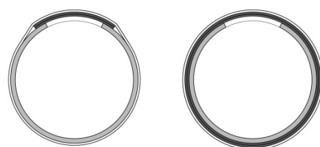
(a) 部分補修 (b) 全周補修
