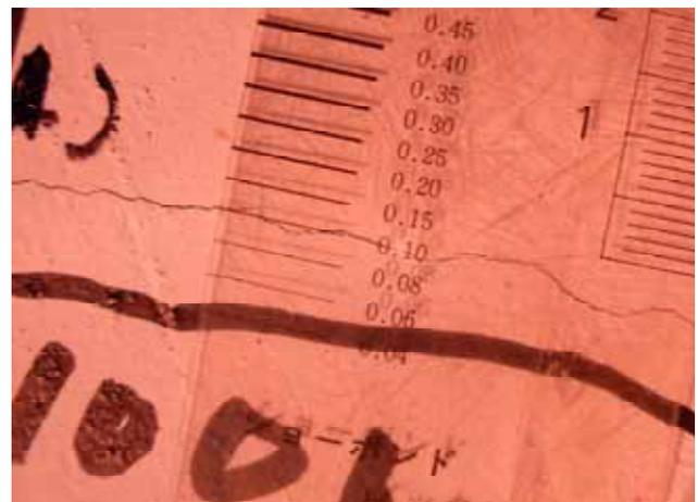
写真-3 設計荷重時のひび割れ幅
