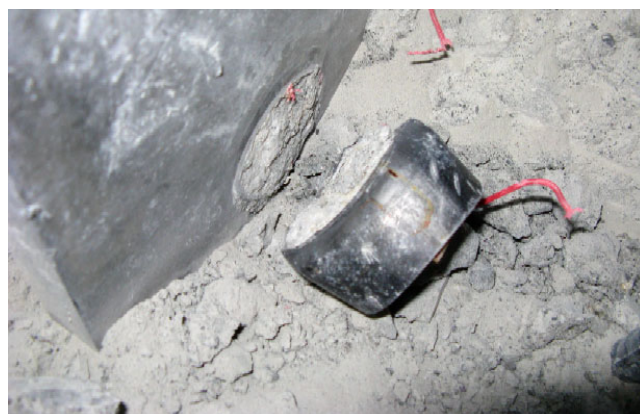
写真-3 疲労試験における鋼パイプの破壊状況
