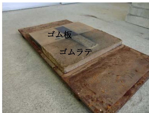
写真 3. ゴム板を使用した試験後供試体
