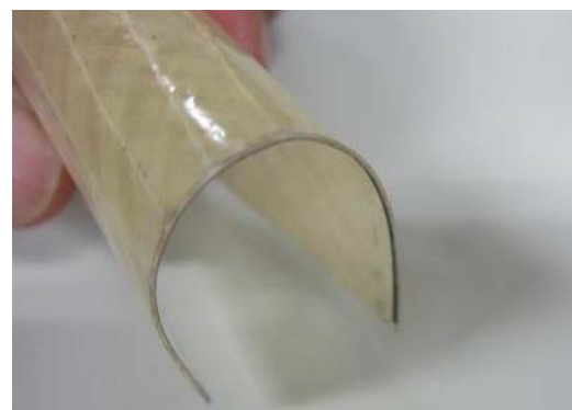
写真 5. 柔軟性 MMA 樹脂の GFRP
