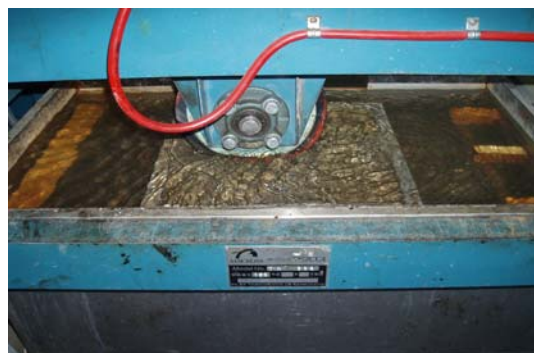
写真2 水浸ホイールトラッキング(水温 60℃)
