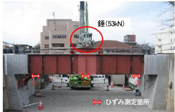
図-5 載荷試験の状況
