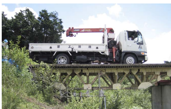
図-6 荷重車による載荷試験状況(2009 移設前)
