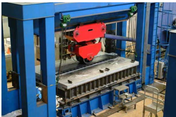
写真-3 輪荷重走行試験実施状況
