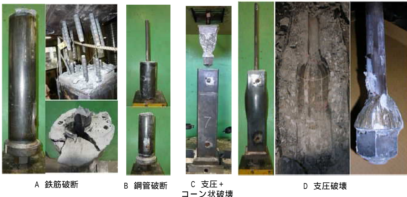
写真2 最終破壊状況例
