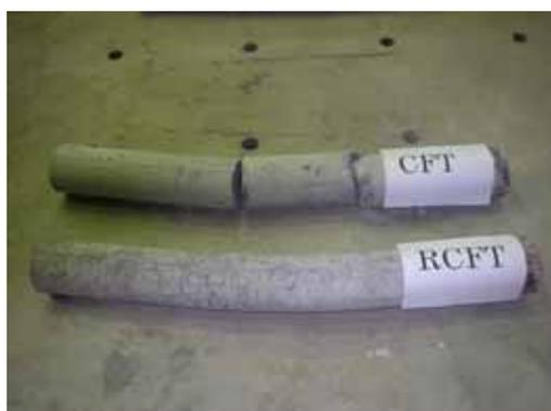
写真-2 曲げ試験破壊状況
