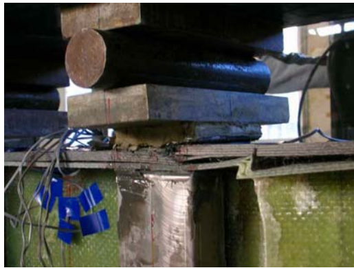
試験体 A 破壊状況
