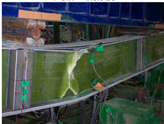
試験体 C 破壊状況
