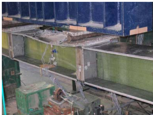
写真-3 試験体 A (250mm フランジ幅) の座屈変形
