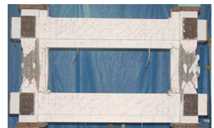
図-7 試験体 NRF1 の最終破壊状況
