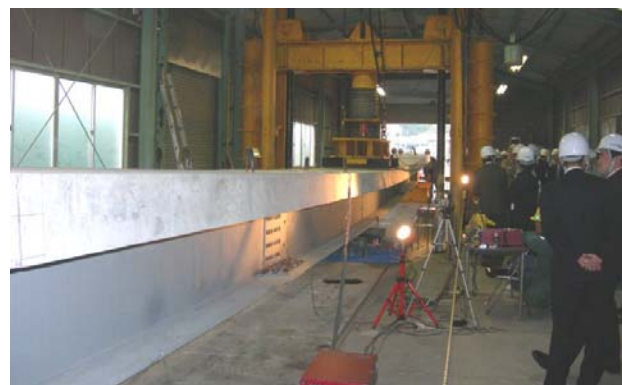
写真-2 曲げ载荷試験状況
