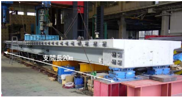
写真-1 疲労試験状況
