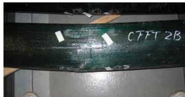
図 13 CFFT 2B の破壊形状
