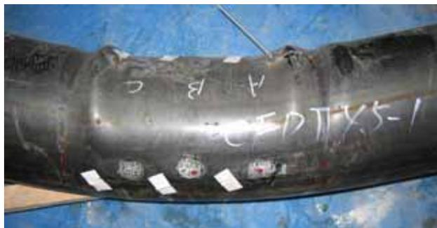
図 10 CFDT 外鋼管の座屈
