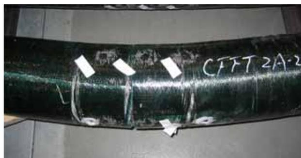
図 12 CFFT 2A の破壊形状
