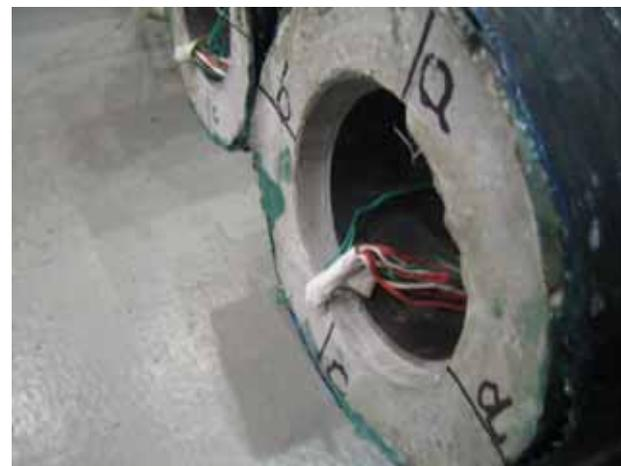
図 14 CFFT の内鋼管とモルタルのずれ
