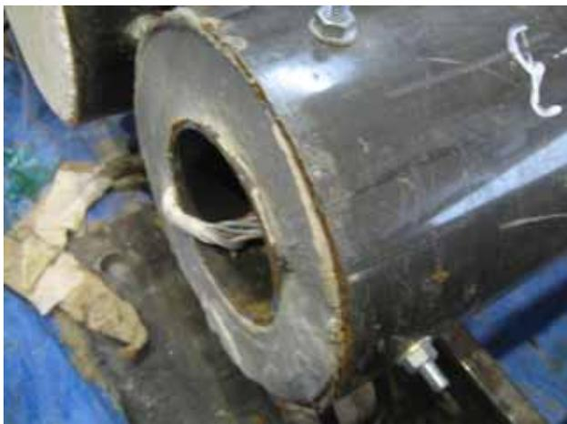
図 11 CFDT の鋼管とモルタルのずれ
