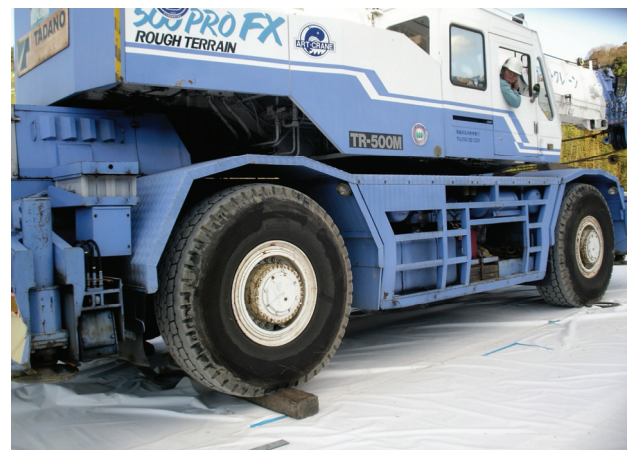
(b) クレーン車による加振
